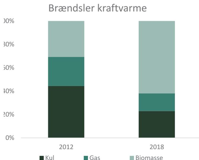
Figur 3: Brændselstyper benyttet på kraftvarmeværker.<sup>7</sup>
